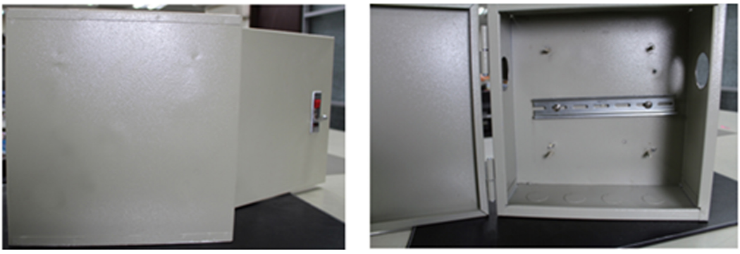
Caisson avant fixation du rail DIN Caisson après fixation du rail DIN
